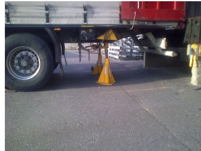
Pilares de remolque
